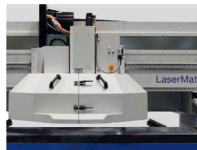
带有光栅的激光车载保护罩允许直接起重机装载以及在切割操作期间装载和卸载
